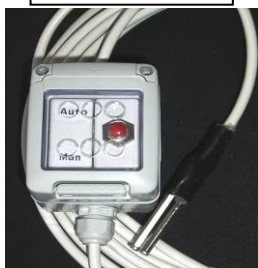
Sensore di livello per travaso
