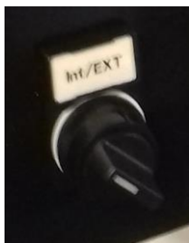
Selettore Int/EXT per collegamento comandi remoti
