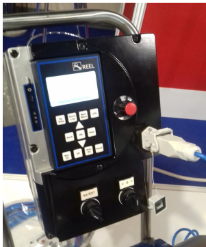
Potenzimetro graduato e numerato e comandi di marcia disponibili a bordo inverter
