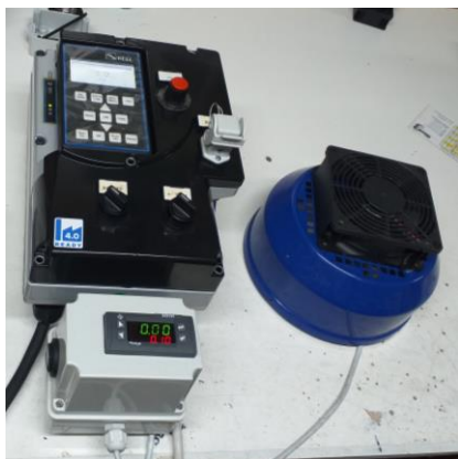
Esempio di sistema Inverter, Timer e servo ventilazione
