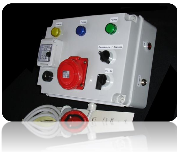
Quadro sensore di livello versione universale con presa di allaccio pompa a bordo quadro (dimensioni 300 x 240 x 70)
